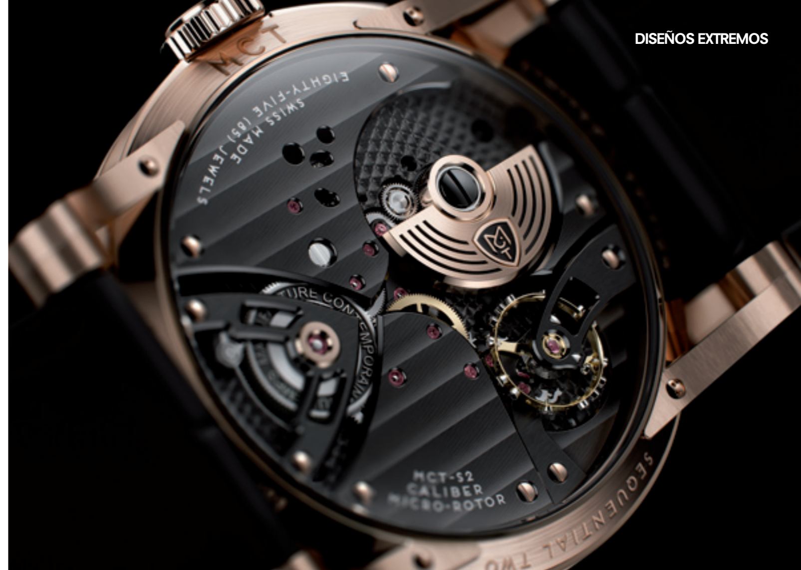
El fondo del reloj, con el microrrotor, el órgano regulador y el barrilete a la vista.
